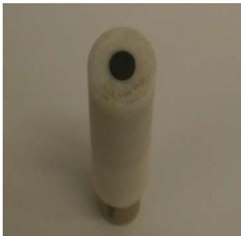
**Figura 3.1** – Eletrodo de disco rotatório de grafite.
